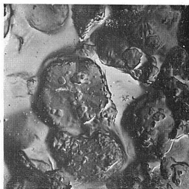
写真 10 U<sub>3</sub>O<sub>8</sub>I 700°C2時間
